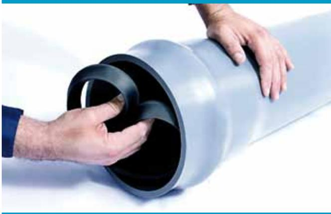
**4** Aplicar el lubricante en la parte expuesta del anillo de caucho y de la espiga del tubo a instalar.
