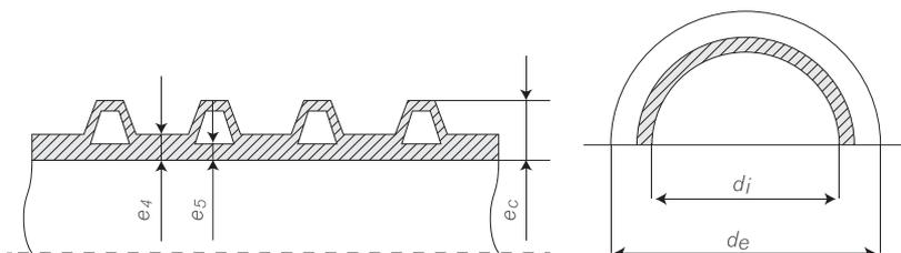
Los espesores de pared de las capas internas y externas cumplen con lo establecido en la norma técnica de requisitos.
