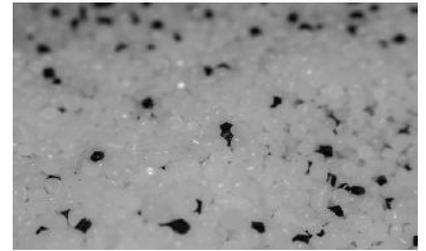
El Polietileno se obtiene por polimerización del Etileno sometiéndolo a presión y temperatura. A la salida de los reactores el PE es un polvo fino de color blanco, al que se incorporan aditivos para mejorar la resistencia a la luz y al calor.
